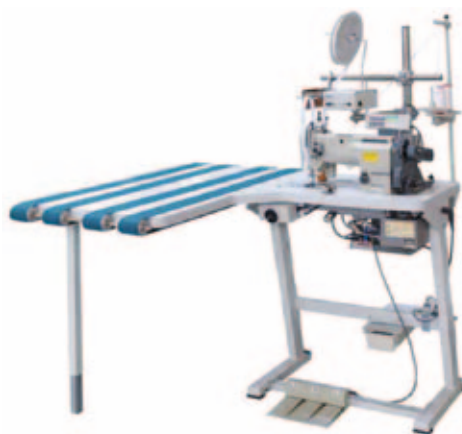
Mit dem Nähautomaten Cronos-L kann man Flauschbänder oder Litzen gleichzeitig mit dem Seitensaum vernähen.
